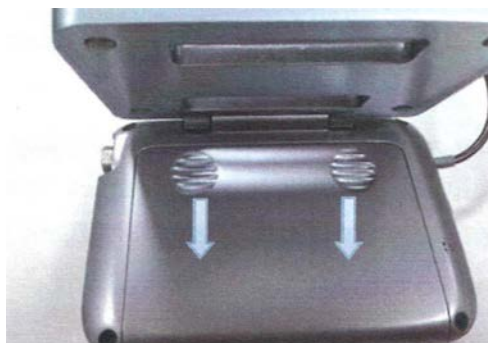
Imagen 3-2. Cambio de batería
