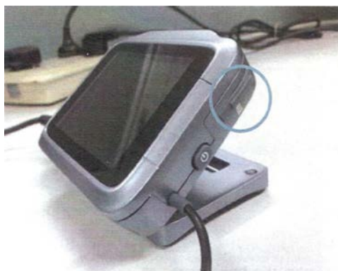
Imagen 3-3. Instalación de la tarjeta SD.
