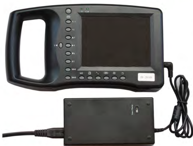
Carga de la batería al ecógrafo
